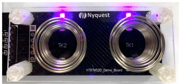
2. LED 放置在 Touch Pad 下面，則可以作背面焊接的方式，且 PCB 開孔做為透光功能，這種做法則觸摸面板不需要挖洞，但透光效果沒有放正面的好。
